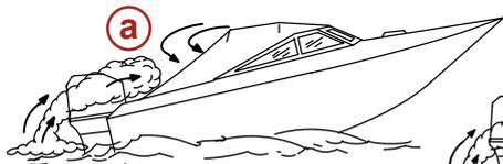
**a** - Эксплуатация катера со слишком большим углом носового дифферента.
