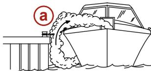
**a** - Работа двигателя, когда катер пришвартован в замкнутом пространстве.
